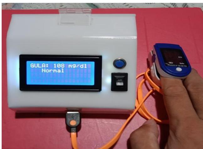
**Gambar 4. Alat pemantau asam urat sederhana yang dirancang**
